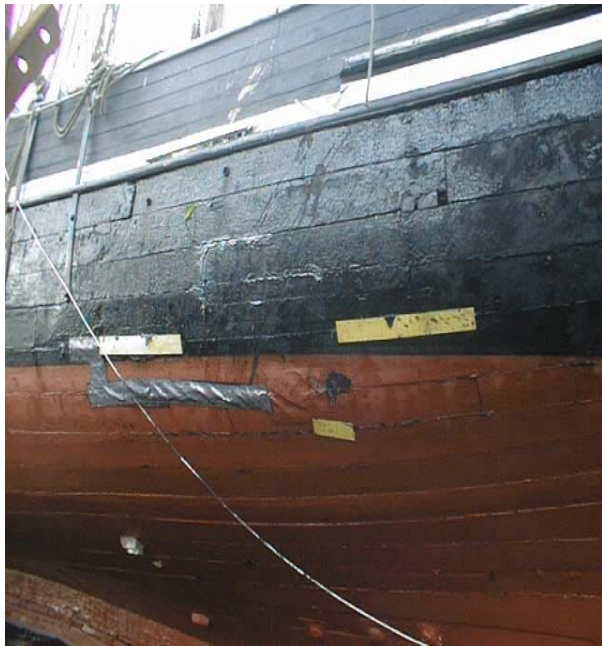
Bagbord side med midlertidige reparationer for at sikre at MARTHA kunne flyde fra kajen til beddingen.
