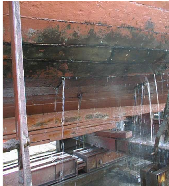
Styrbord side og den beskadigede stråkkøl
